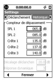
Lorsque le mode de déclencheur a été sélectionné, les niveaux de déclencheur sont réglés dans l'onglet Trigger (Déclencheur) de l'écran Settings (Réglages).
