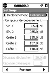
La page « Triggers » permet de définir les niveaux de déclenchement associés aux événements de dépassement, c'est-à-dire lorsque le niveau sonore mesuré (niveau de bruit perçu ou crête) dépasse l'un des niveaux de déclenchement définis par l'utilisateur. La variation du niveau sonore pendant un événement type pourrait ressembler à la courbe ci-dessous.
