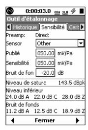
Il peut y avoir des situations où le préamplificateur du microphone livré avec le Modèle 831 n'est pas utilisé. Par exemple, quand un hydrophone est utilisé, aucun calibreur de niveau sonore n'est disponible, donc la sensibilité doit être saisie directement par l'utilisateur.
