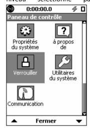
Pour activer la page Lock (Verrouillage), appuyez sur la touche 3, mettez en évidence l'icône Lock (Verrouillage) et appuyez sur 5.
