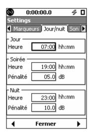
Les paramètres mesurés et affichés dans les mesures de niveau sonore de base incluent les descripteurs de bruit ambiant LDN et LDEN. La page « Day/Night » permet de définir les heures et les pénalités à utiliser.
