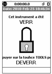
Si l'option Fully Locked (Verrouillage complet) a été choisie pour le mode de verrouillage, après confirmation, cette icône représente ce qui sera affiché. À ce moment, l'instrument n'effectue pas un mesurage. Il est possible de sélectionner le mode Fully Locked (Verrouillage complet) pendant un mesurage.
