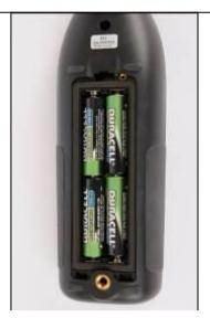
Couvercle des piles retiré 4 piles AA installées
