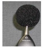
Le vent soufflant sur le microphone génère des fluctuations de pression sur la membrane du microphone, ce qui peut causer des erreurs de mesure. C'est pourquoi, en présence de vents faibles, il est recommandé de placer un écran anti-vent sur le microphone. Larson Davis offre l'écran anti-vent WS001, une boule de 9 cm de diamètre faite en mousse cellulaire à cellules ouvertes, qui peut être placée sur le microphone et le préamplificateur.
