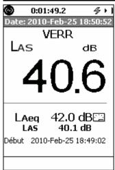
Si le mode Locked w/Auto-Store (Verrouillé avec enregistrement automatique) a été sélectionné, après avoir accepté les modifications dans la page Lock (Verrouillage), cette icône représente ce qui sera affiché.
