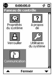
Pour activer la page Communications, appuyez sur la touche 3, mettez en évidence l'icône Communication et appuyez sur 5. Veuillez noter que l'icône de communication est estompée et n'est pas disponible jusqu'à ce que le port hôte USB soit activé dans System Properties (Propriétés du système). Si l'icône de communication est désactivée, assurez-vous que le port hôte USB a été activé (On) et que l'option Advanced Communication (Communications avancées) est activée.
