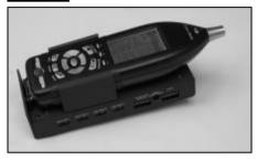
Le 831-INT est un périphérique qui se raccorde au Modèle 831 à l'aide du connecteur d'entrées-sorties du 831 et qui augmente les capacités du 831, procurant une interface pour tous les composants nécessaires à la mise en place d'un dispositif permanent de surveillance des sons. Les composants suivants sont compris :
